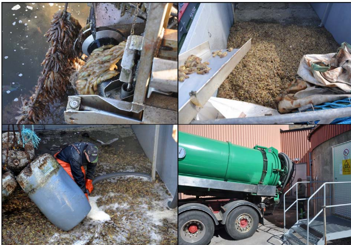
Figur 16. Skörd och transport av ascidier ( Ciona intestinalis ). Händelseförlopp från övre vänstra bilden: Ascidier skördas från odlingsbanden (~17 kg/lpm). Biomassan skördas tills förvaringsutrymmet är fullt. Biomassan suggs upp med slamsugningsbilens slang. Biomassan körs till Långeviksverket (Lysekil) för rötning. Ts = 5 %. Numera mixas biomassan direkt efter skörd vilket ökar pumpbarheten.
